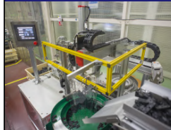
自動圧入機 Automatic pressfitting of Parts
