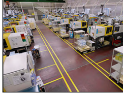
クリーンルーム Clean room ISO 14644-1 Class8
