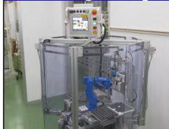
自動ネジ締め機 Automatic screw tightening
